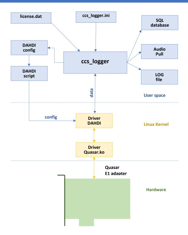
Выходными файлами для ccs\_logger являются база данных (SQL database), директория с аудио данными (Audio pull), файл с историей соединений (LOG file). Конфигурация программы задается в файле ccs\_logger.ini. На основе этой конфигурации автоматически создается конфигурация драйвера DAHDI config, которая скриптом DAHDI script загружается при старте программы.
